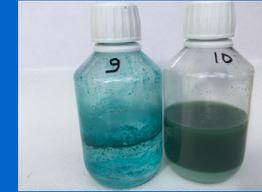
9.) solution de sulfate de Cu plus oléate de Na. -> tout le Cu est sous forme huileuse.
