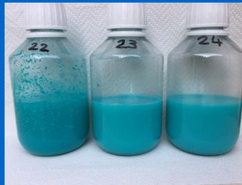
Même conditions expérimentales que pour la synthèse : flacon 22, la solution de savon est versée dans la solution de Cu. Flacon 23 avec 8 g de Mouillant Biofa, flacon 24 avec 6.9 g.
