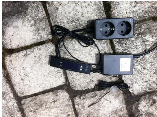
*Photo 6: Thermostat avec la prise pour les lampes chauffantes, le dispositif pour fixer la température et la sonde de mesure, en bas au milieu.*
